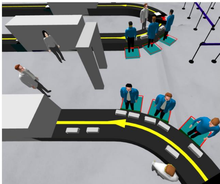
Obr. 5 Model automatické trati s paralelní přípravou cestujících (zpracováno v programu CAST) [4]
