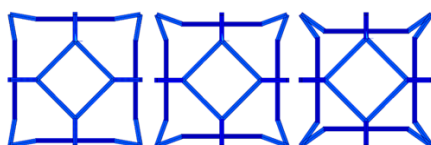
Obr. 3: Vliv zvětšující se velikosti re-entrantního úhlu na geometrii elementární buňky (zleva doprava)
